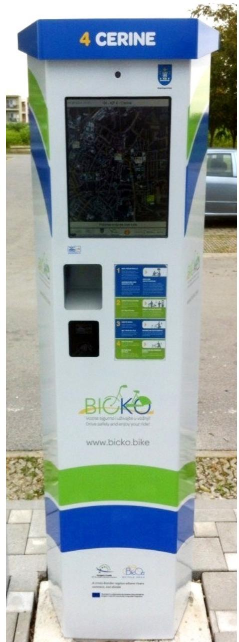
Kao što prikazuje slika sustav je isto tako moguće postaviti i bez građevinskih radova tamo gdje je ravna i čvrsta podloga postolja i pilon se mogu montirati na aluminijsku ploču koju onda kemijskim tiplama učvrstimo za podlogu.
