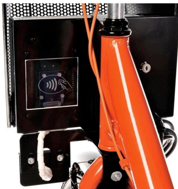
Bicikle je isto tako moguće i zaključati izvan stanice ili sa RFID karticom ili sa mobilnom aplikacijom ili sa kodom, a ujedno je moguće korištenjem GPS lokatora i pronaći slobodnu biciklu i istu rezervirati i rezervirati.
